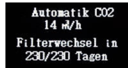
Anzeige der Lüftungsstufe, Volumenstrom und Filterrestlaufzeit
