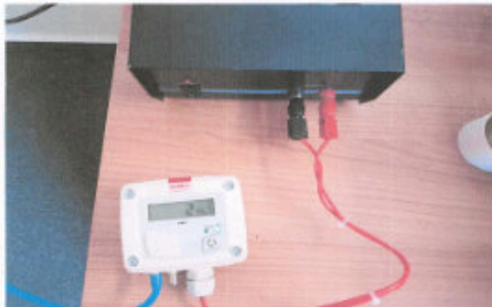
9:46 Uhr Streambox mit Förderleistung von 50 m 3 pro Stunde Zuluftöffnung abgedichtet Differenzdruck 2 Pa
