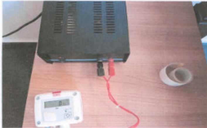
9:25 Uhr Streambox ausgeschaltet.; Zuluftdüse abgedichtet Druckdifferenz 0 Pascal (Pa)
