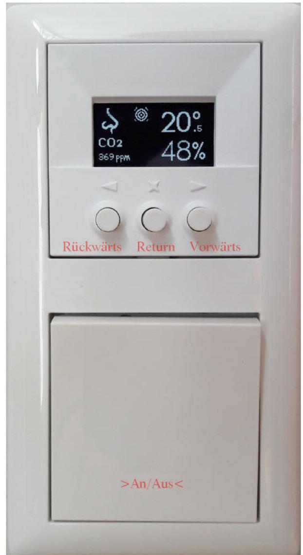
In die Doppelinstallationsdose (System „Gira“) wird unten ein Schalter für die 12V-Stromversorgung eingebaut und oben das Display mit den Tasten für die Ansteuerung. Die beiden Pfeiltasten sind die Navigations-Taster, der mittlere mit dem Stern ist die Quittiertaste (Return). Alle Eingaben der Modussteuerung und die des Untermenüs werden über diese drei Tasten bedient.
