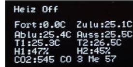
„Heiz Off“ bedeutet hier, dass die elektrische Frostschutzheizung nicht aktiv ist. Diese Heizung schaltet sich automatisch bei bestimmten Temperaturverhältnissen ein, wenn der Wärmetauscher Gefahr läuft, einzufrieren. Das darf nicht passieren, denn das könnte den Wärmetauscher beschädigen.
