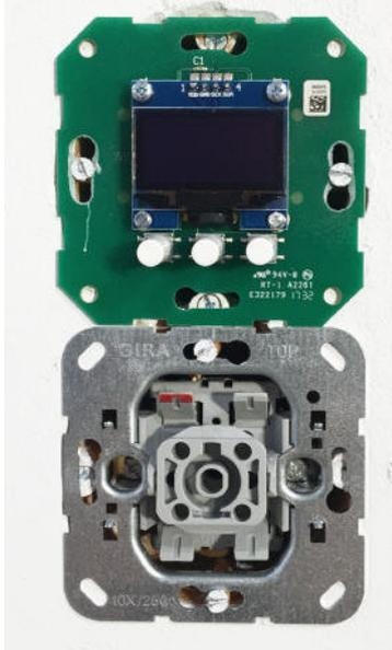
Der Rahmen des Schalters und die Unterkante der Displayplatine sollten direkt aufeinander liegen. Wenn das Displayboard und Schalterrahmen nicht korrekt ausgerichtet sind, kann die nun schief sitzende Displayblende die Taster verklemmen, was zu Funktionsstörungen führt, weil dann die Taster nicht sauber auslösen.
