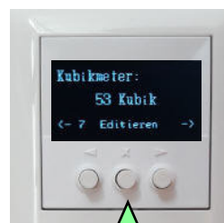
Übernehmen Sie den Wert wieder mit der Mitteltaste. Verfahren sie so mit allen weiteren Werten, die Sie ändern möchten. Wenn Sie alle Einstellungen durchgeführt haben, dann...
