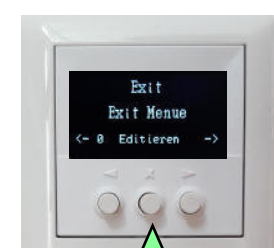
...navigieren Sie wieder zum Eintrag „Exit“ (0) und drücken Sie zum Verlassen des Untermenüs die Mitteltaste.
