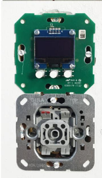
Der Rahmen des Schalters und die Unterkante der Displayplatine sollten direkt aufeinander liegen. Wenn das Displayboard und Schalterrahmen nicht korrekt ausgerichtet sind, kann die nun schief sitzende Displayblende die Taster verklemmen, was zu Funktionsstörungen führt, weil dann die Taster nicht sauber auslösen.
